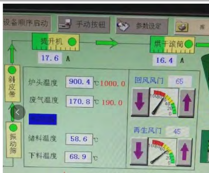
图 2-2 燃烧机 TA003 燃烧温度（控制电脑显示温度）
