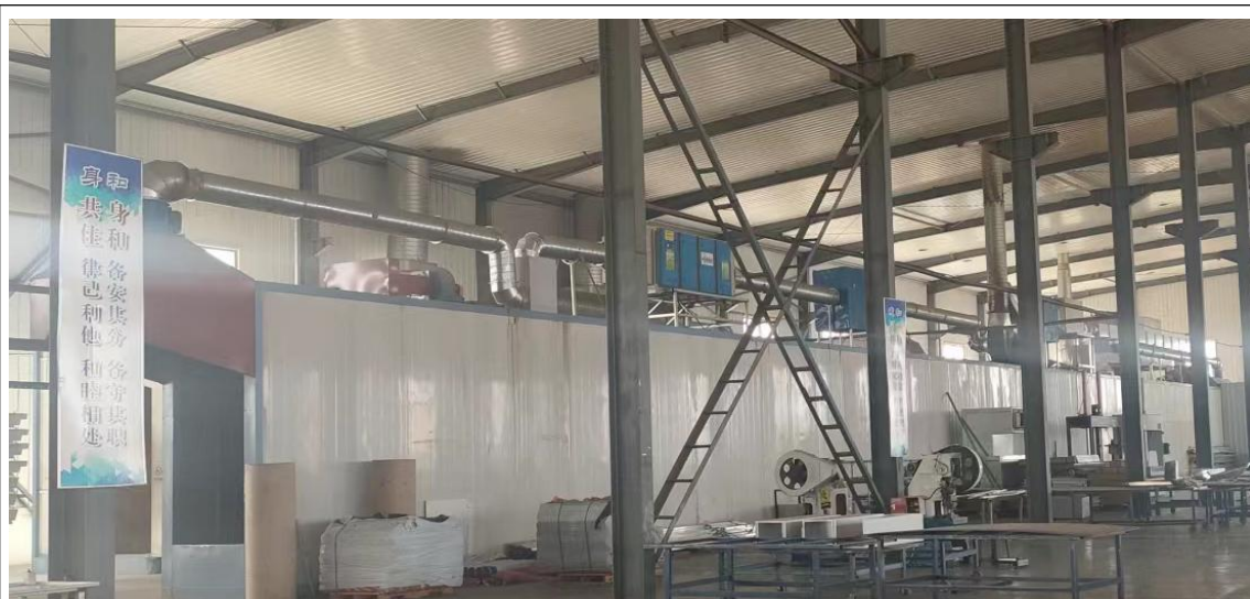
滤筒除尘器+UV 光氧催化+活性炭吸附装置
