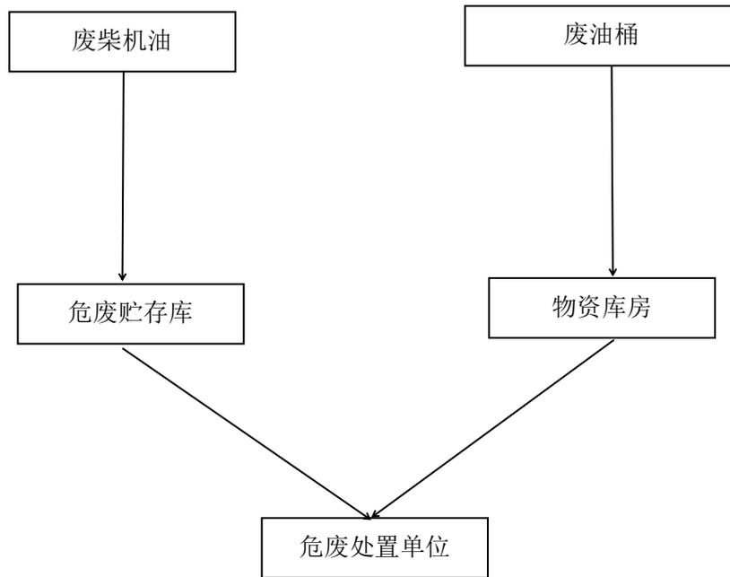
天湖铁矿生产区所产生的的更换下来的废柴机油和设备润滑保养的废油桶中，废柴机油贮存至矿区专用危废库房，承装润滑脂的空油桶存放于专用物资库房，按年拉运至危废处置单位进行处置，废柴机油和废油桶属于《国家危险废物名录（2021 版）》中 HW08 类，废柴机油代码为：900-214-08，废油桶代码为：900-249-08。
