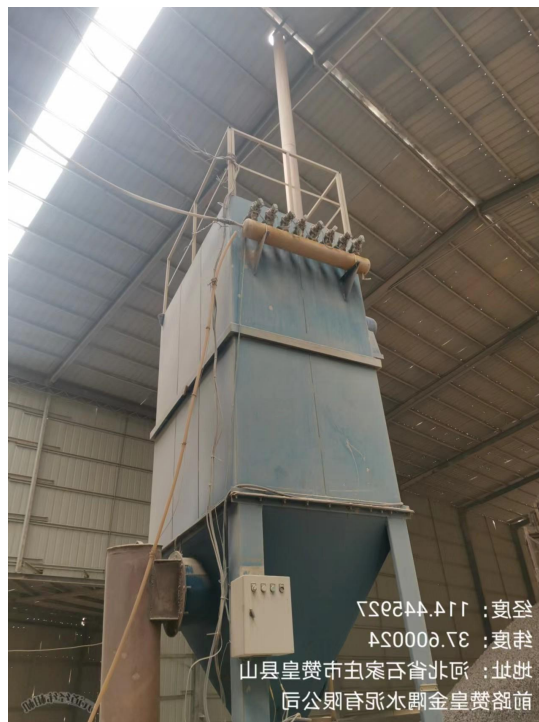
二级破碎工序布袋除尘器
