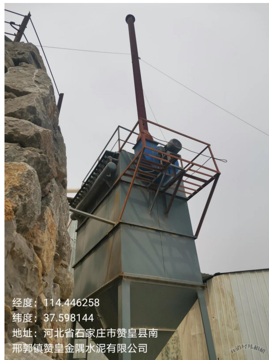
一级破碎工序布袋除尘器
