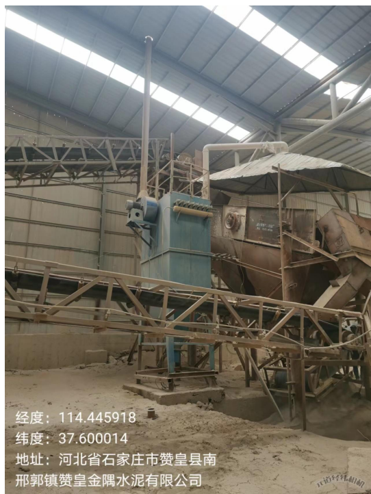
1#筛分工序集气装置及布袋除尘器
