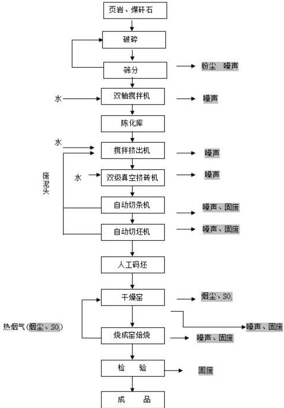
图 1 工艺流程及排污节点图
