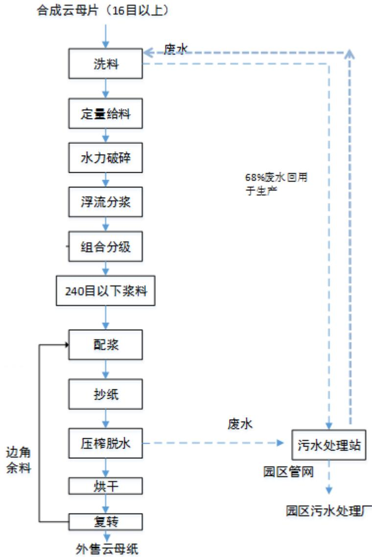
图 1 工艺流程及排污节点图
