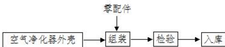
图 3.4 空气净化器组装工艺流程图
