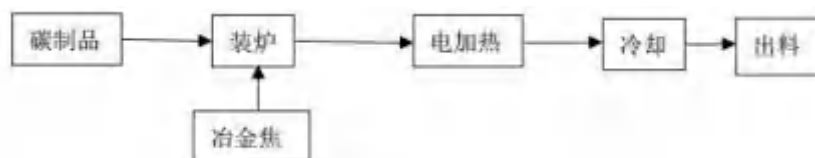
图 3.5-4 碳素厂生产工艺流程图
