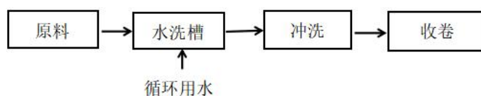
图2 现有项目水洗线工艺流程图
