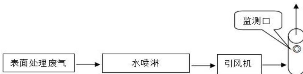
图 6-2 喷粉木纹车间废气监测布点图
