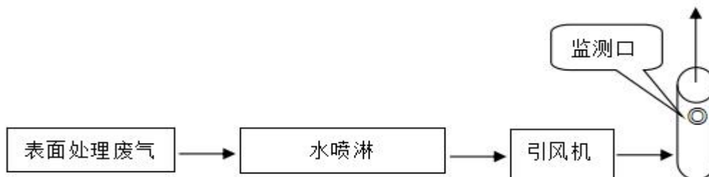
图 3-3 表面处理废气处理工艺流程图
