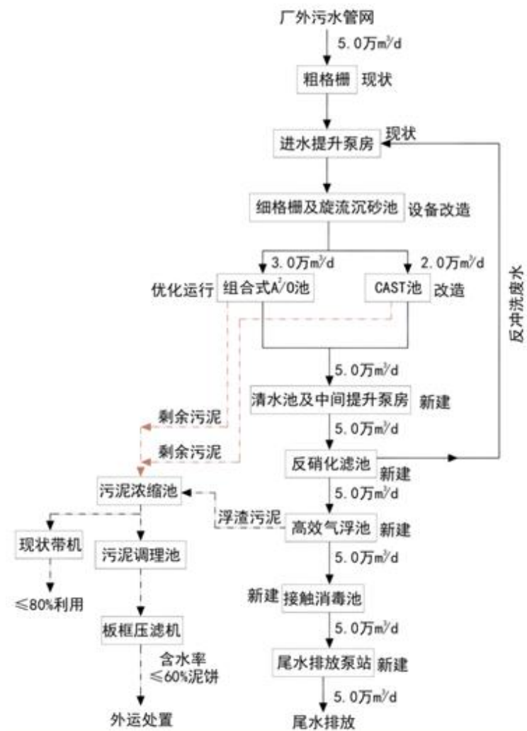
图 7-3 无锡市钱桥污水处理有限公司处理工艺
