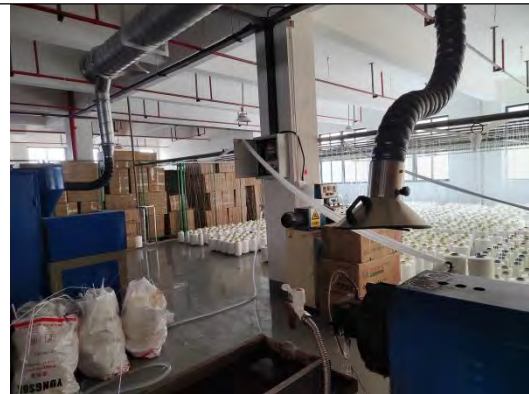
挤出机出料口上方的集气罩现场照片
