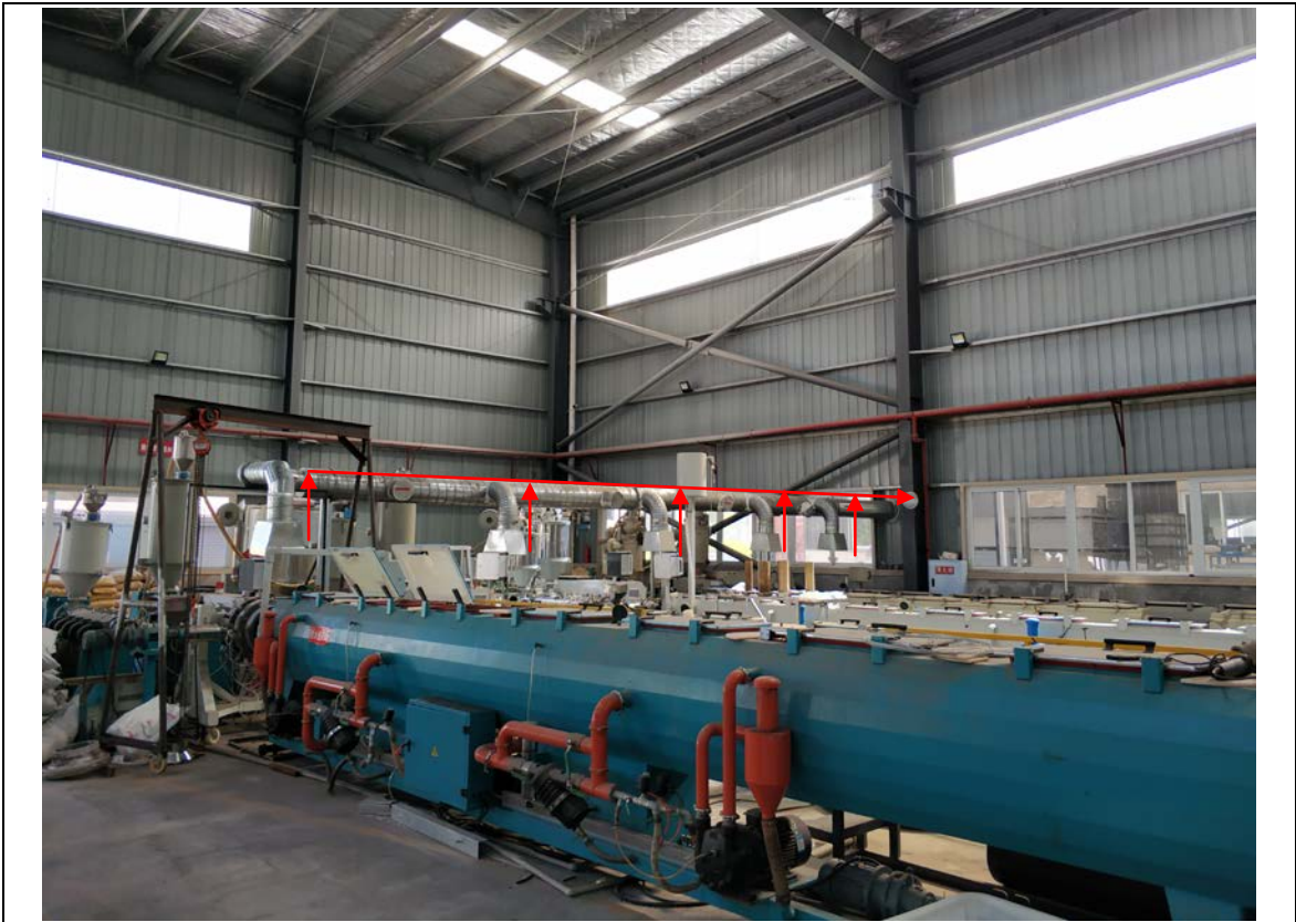
废气集气罩（挤塑区）
