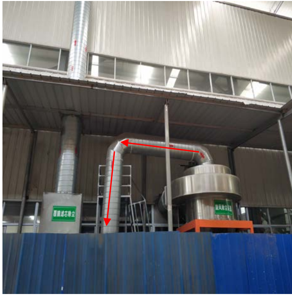
大旋风除尘装置+覆膜滤芯除尘（手动喷塑）
