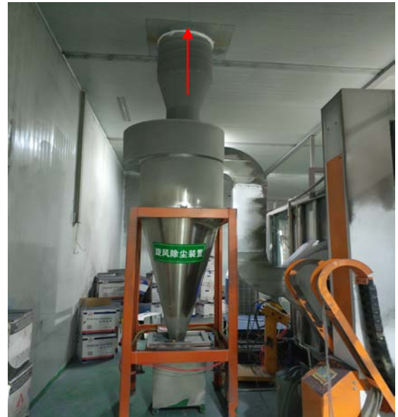
小旋风除尘装置（自动喷塑）
