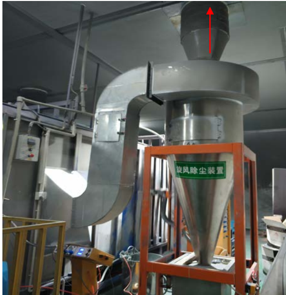
小旋风除尘装置（自动喷塑）
