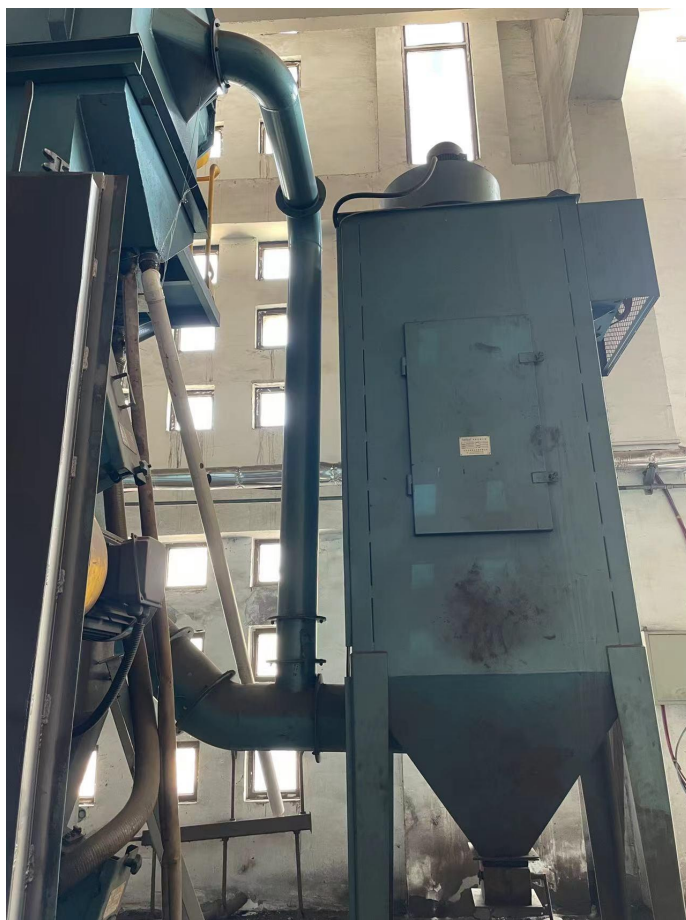
图 4-1 抛丸废气处理设施
