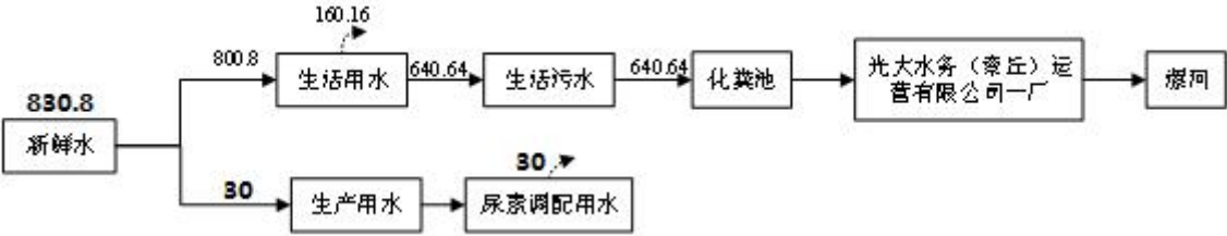
图 2-2 全厂水平衡图 (单位: m³/a)
