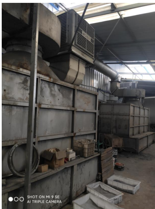
打磨粉尘除尘装置
