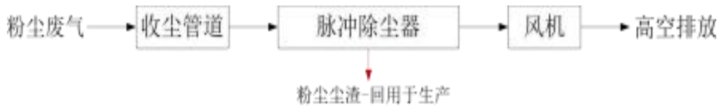
图 4 粉尘废气处理工艺
