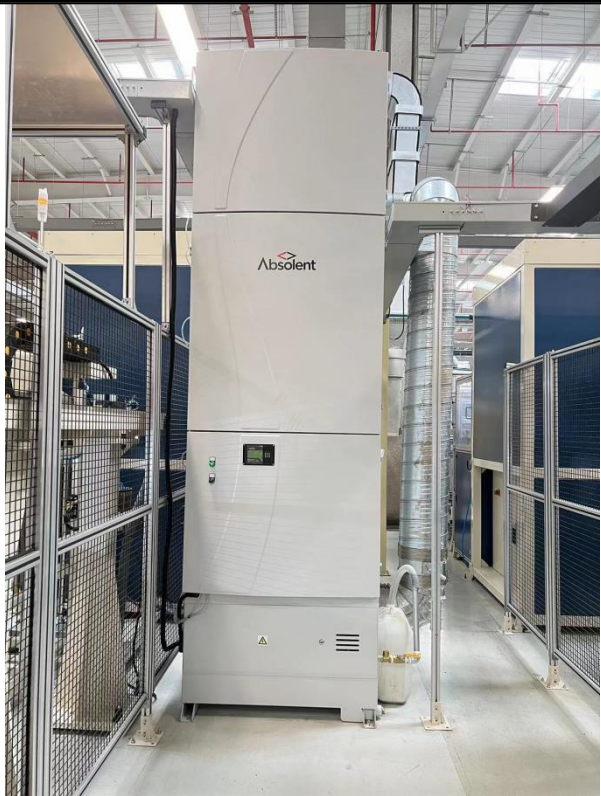
生产线废气处理设施（油烟净化器）
