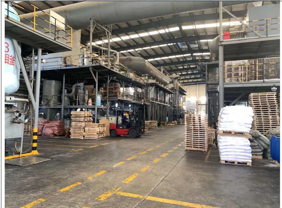
生产车间：生产过程中原辅材料可能对土壤和地下水产生污染，现场踏勘显示地面均已硬化，并铺设环氧地坪，地面完好无破损裂痕。
