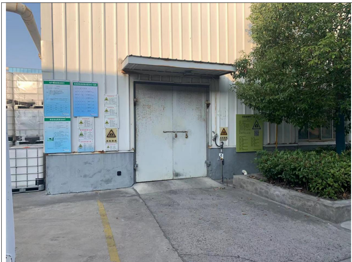
危废仓库：危废仓库存储的危险废物会对土壤和地下水产生污染，现场踏勘显示地面均已硬化，并有防水防渗涂层，地面完好无破损裂痕。
