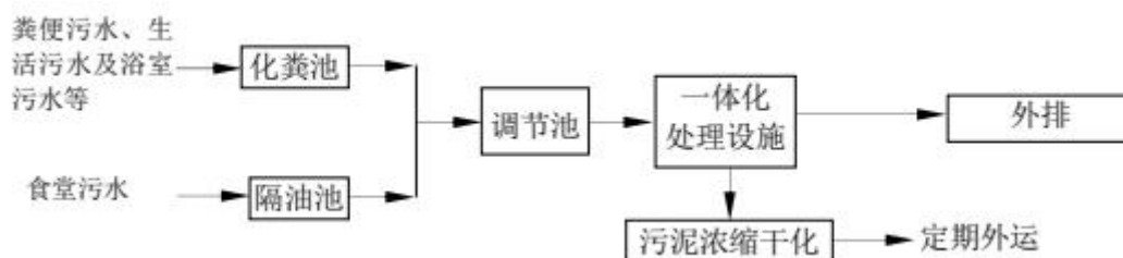
图 7.2-2 生活污水处理工艺流程图
