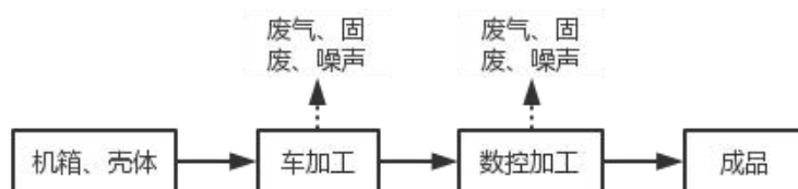
图 2-6 铝制品工艺流程及产污环节图
