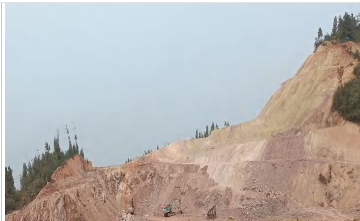
采区剥离土分台阶分层施工现场照片
