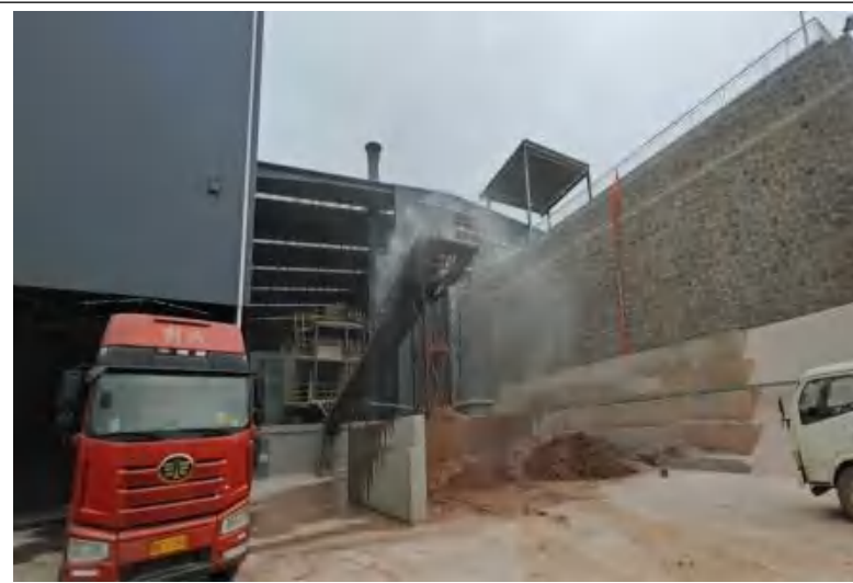
尾筛喷雾降尘装置
