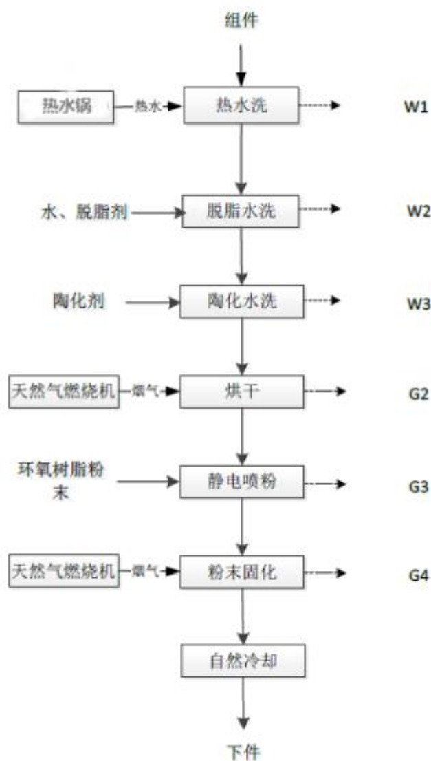
图2-2 生产工艺流程及产污节点图
