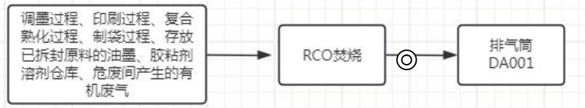
图 3-1 废气处理和排放示意图 ◎监测点位
