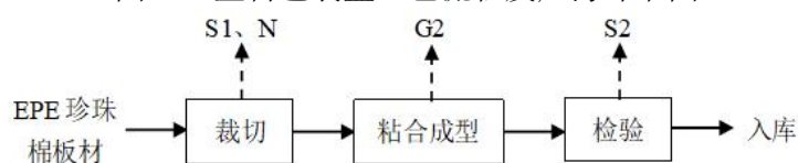
图 4-2 珍珠棉包装盒生产工艺流程及产污环节图
