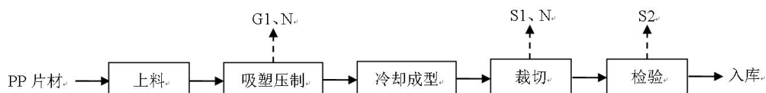
图 4-1 塑料包装盒工艺流程及产污环节图
