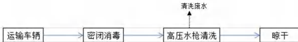
图4 转运车辆清洗工艺流程及产排污节点图
