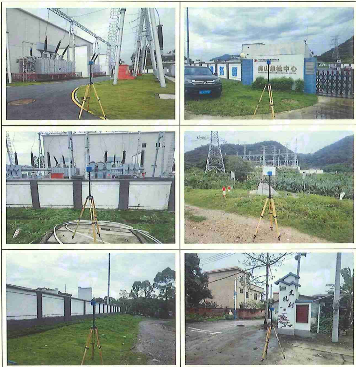
工频电磁场强度检测图片
