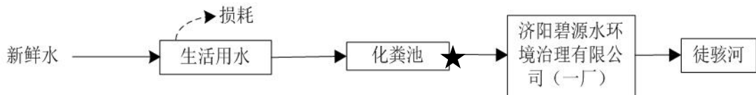
图 3-2 用水和废水处理示意图 ★监测点位
