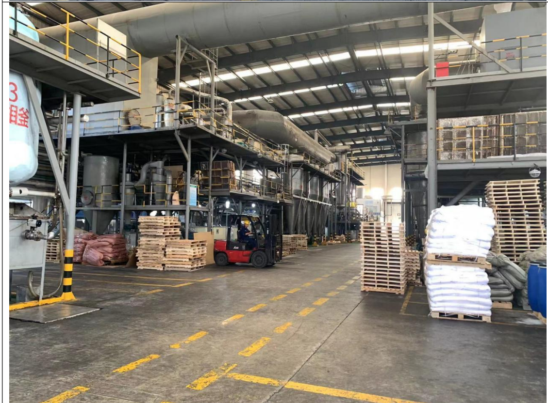
生产车间：生产过程中原辅材料可能对土壤和地下水产生污染，现场踏勘显示地面均已硬化，并铺设环氧地坪，地面完好无破损裂痕。
