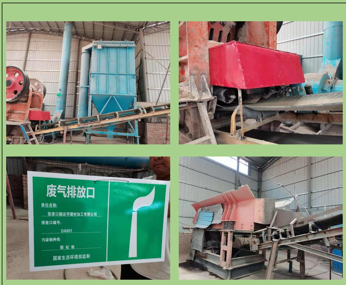
图 4-2 废气收集及除尘器现场照片
