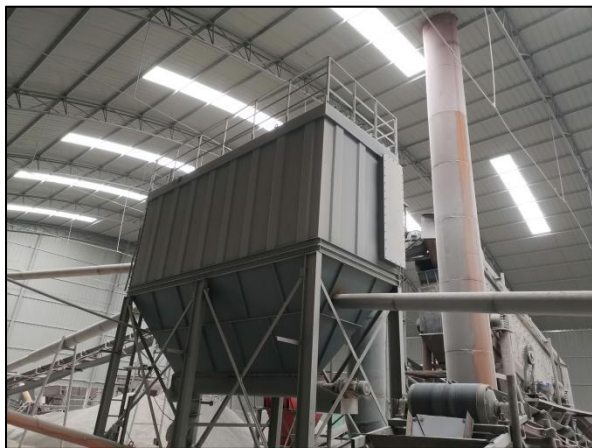
初次破碎筛分单元布袋除尘器
