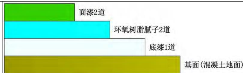
图 4-1 环氧地坪结构示意图
