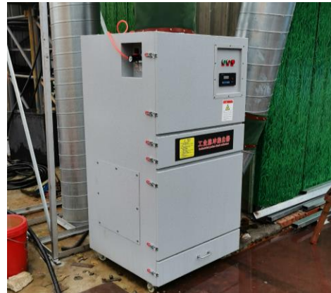
集气罩收集+脉冲布袋除尘器+15m 高排气筒
