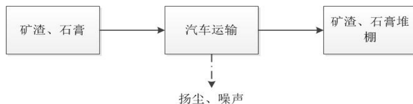
图 2-2 矿渣、石膏堆棚工艺流程及排污节点图
