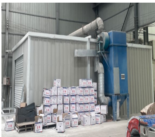
密闭式喷塑房+布袋除尘器
