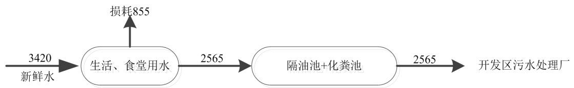
图 2-1 项目一阶段全厂水平衡图 单位:m³/a
