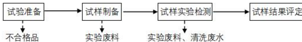
图 2-4 实验室工艺及产污流程图
