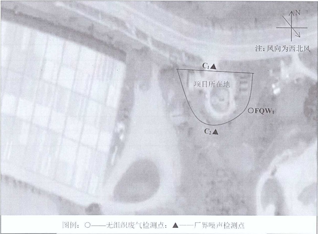
图 1 无组织废气和厂界噪声检测布点示意图
