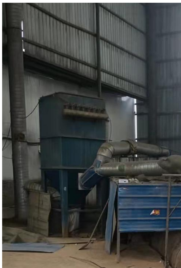
对辊、筛分工序布袋除尘器
