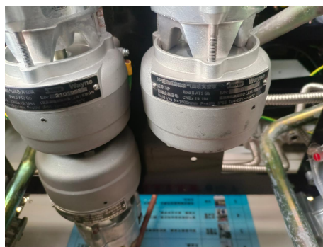
图 3-2 油气回收装置
