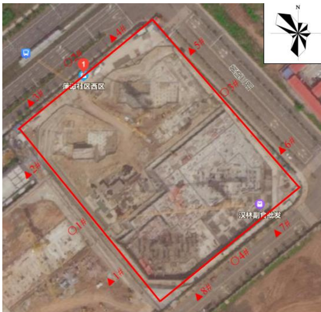
图 6-1 噪声及无组织废气检测点位示意图
